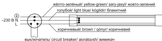
Рисунок / Figure / Сырет/ Рисунок А.3 – Подключение светильника/ Luminaire connection/ Shyraǵdandy qosý/ Підключення світильника
